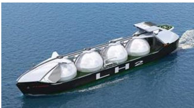
大型液化水素運搬船のイメージ図
