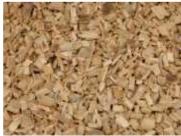
竹は燃えた後にガラス状の灰（クリンカー）が固着してかまを傷めやすく、竹を燃料とするボイラーは普及していない状況です。
