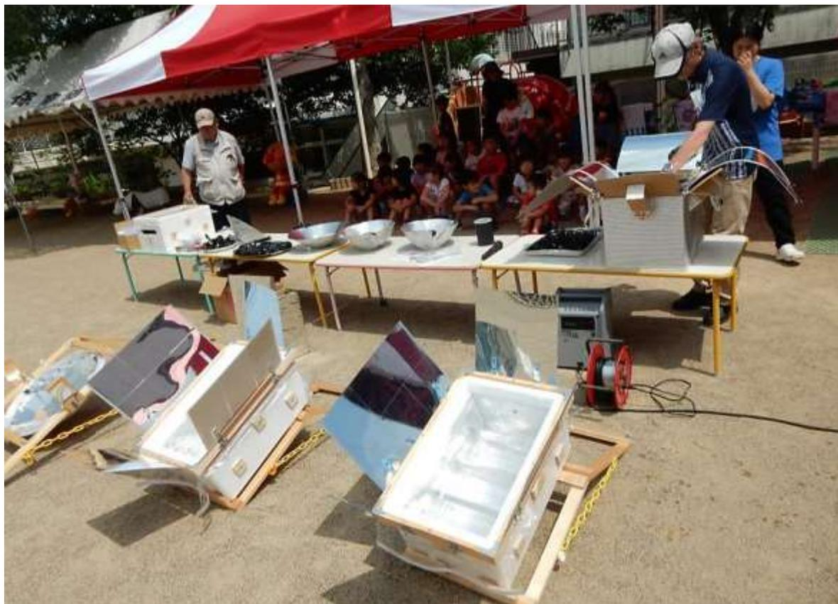
地面に直接設置：左から パラボラ型、熱箱型 2 台
